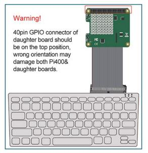
3.在接通Pi400的电源之前,请根据下表仔细检查拓展模块的方向以及针脚1,2和40的位置。
