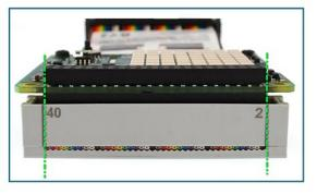
2.确保拓展模块上的针号1,2,40与灰色母连接器上的标记"1,2,40"对齐,然后插入拓展模块到灰色连接器上。
